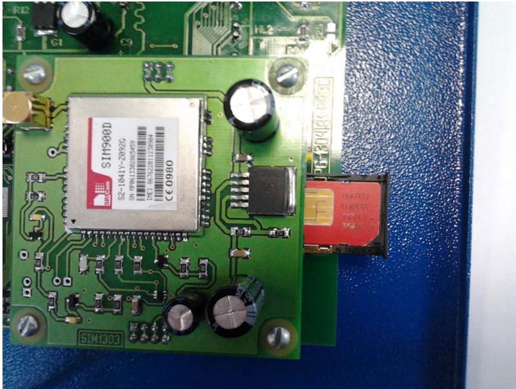
Рис.6.5. Установка лотка на место.
